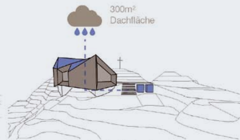
300m 2 Dachfläche Regenwassersammlung über Dach und Speicher im Keller
